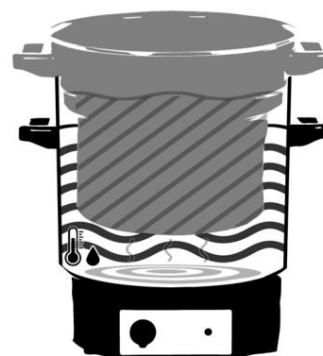
Indirekte Heizung Paraffin in einer Einsatzpfanne in einem mit Wasser gefüllten Kessel
